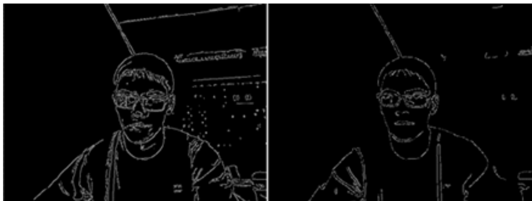
Рис. 1. Кадр без фильтра «сглаживания» (слева) и кадр после применения фильтра (справа)
